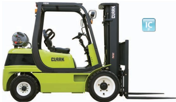
CQ 20/25/30 ГАЗ/ДИЗЕЛЬ Погрузчик с двигателем внутреннего сгорания и пневматическими или суперэластичными шинами 20 25 30 2000 2500 3000 кг
